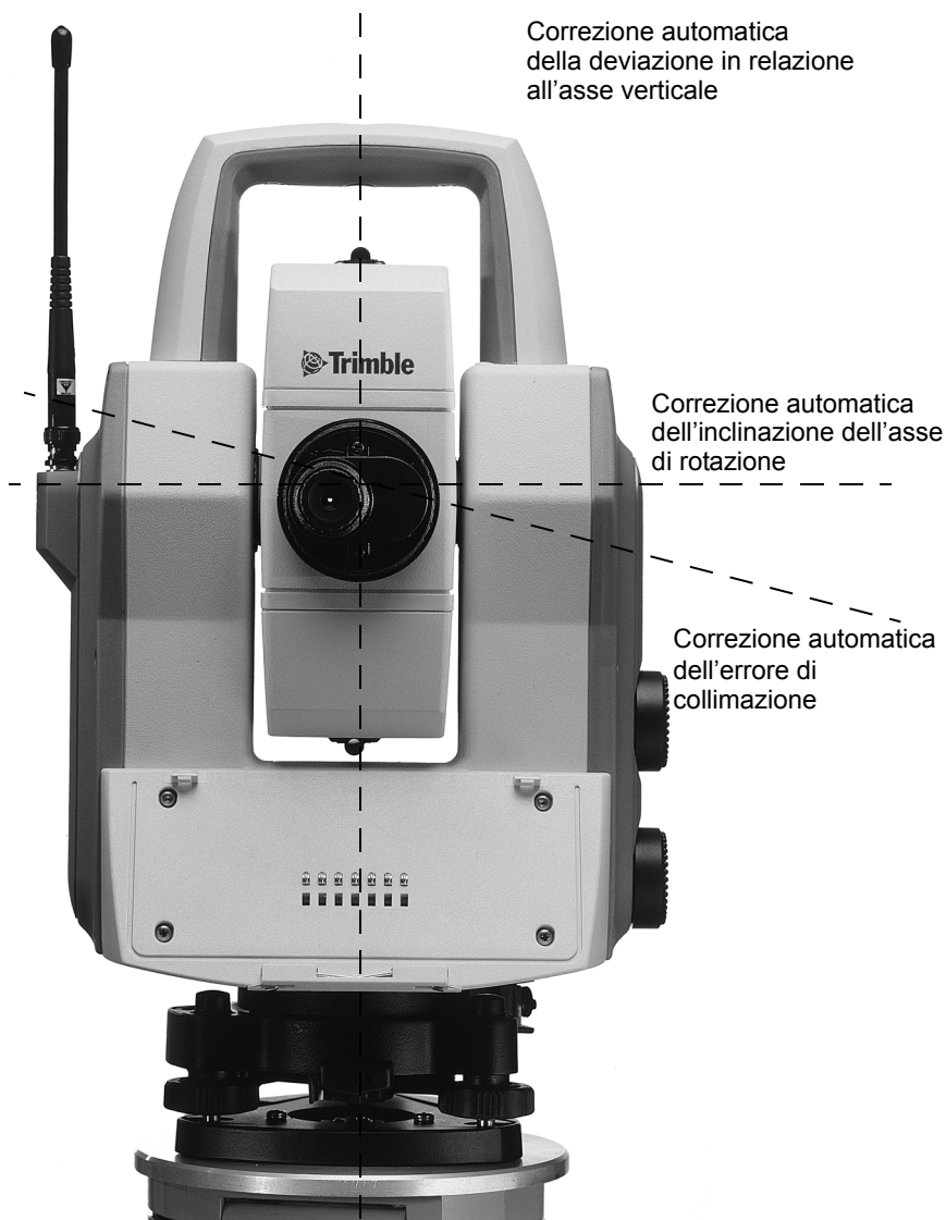
Figura 3.1 Il sistema di misurazione angoli
