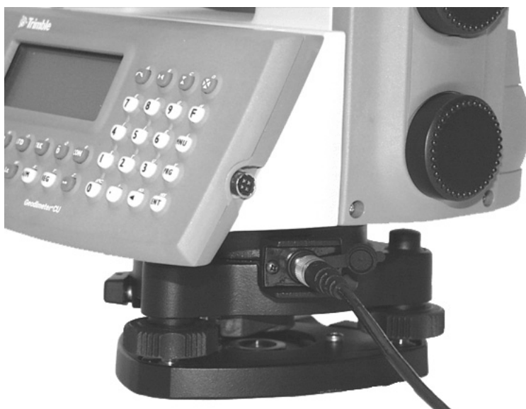
Figura 1.4 Collegare la batteria esterna allo strumento.
