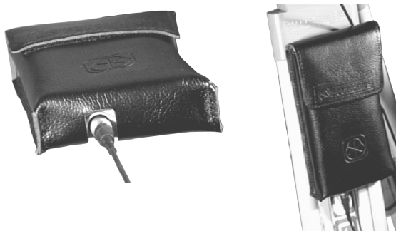
Figura 12.2 Come collegare la memoria a scheda usando il cavo di sistema.
