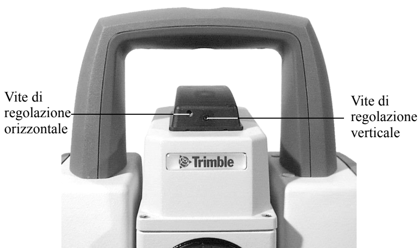
Figura 8.2 Viti di regolazione del puntatore laser
