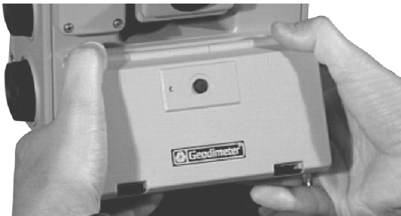
Figura 12.1 Come collegare la memoria a scheda ad uno strumento
